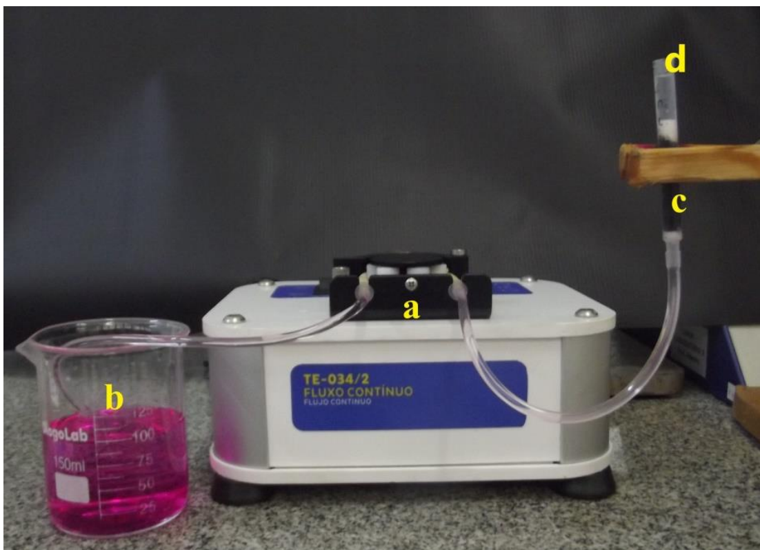
Figura 9. Sistema utilizado para os testes de remoção por adsorção: a) bomba peristáltica b) solução poluente c) seringa contendo o material adsorvente d) retirada de alíquotas.
