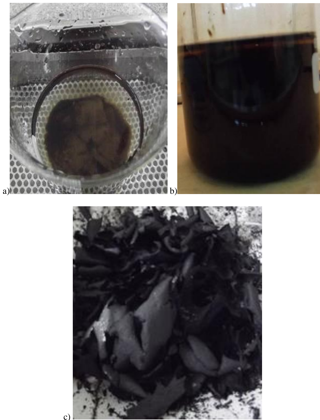
Figura 5. Síntese do grafeno: a) ultrassonificação, b) redução e c) secagem.
