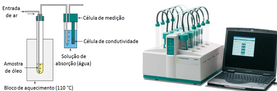
Figura 9. Aparelho de Rancimat, para determinação da estabilidade a oxidação do óleo.
