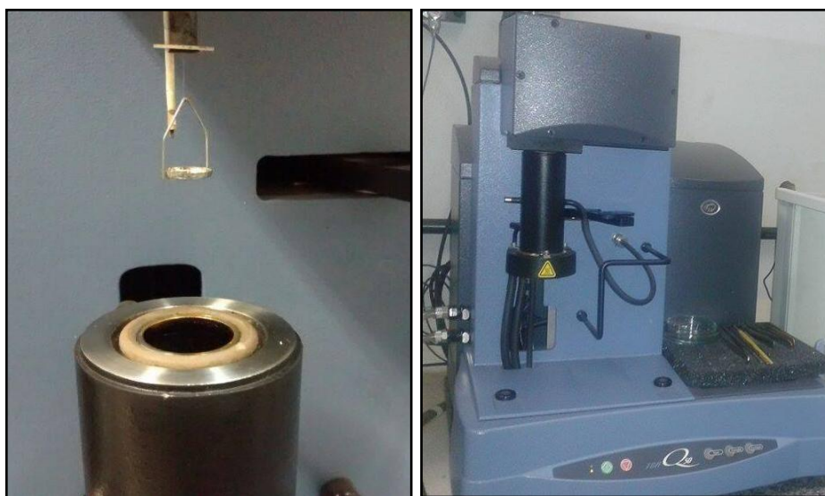
Figura 12. Equipamento de TGA (direita) e cadinho de platina (esquerda).
