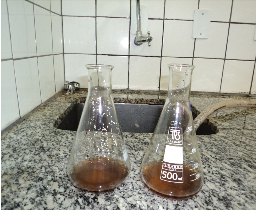
Figura 08: Análise de demanda química de oxigênio da vinhaça. Ponto de viragem após a titulação.
