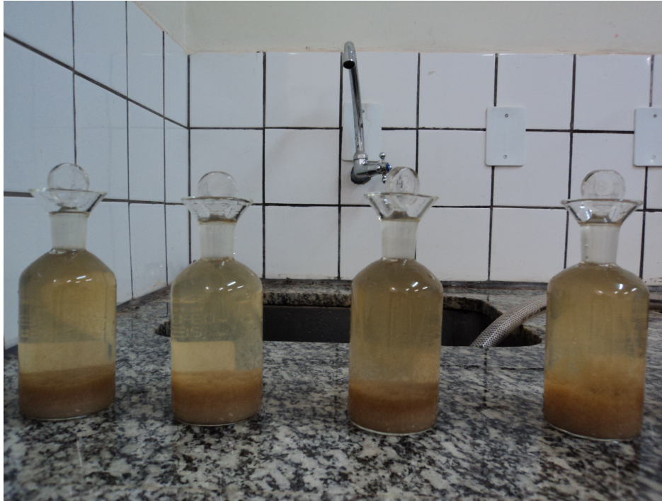
Figura 05: Análise de demanda bioquímica de oxigênio da vinhaça. Após a adição de sulfato de manganês e solução de azida sódica.
