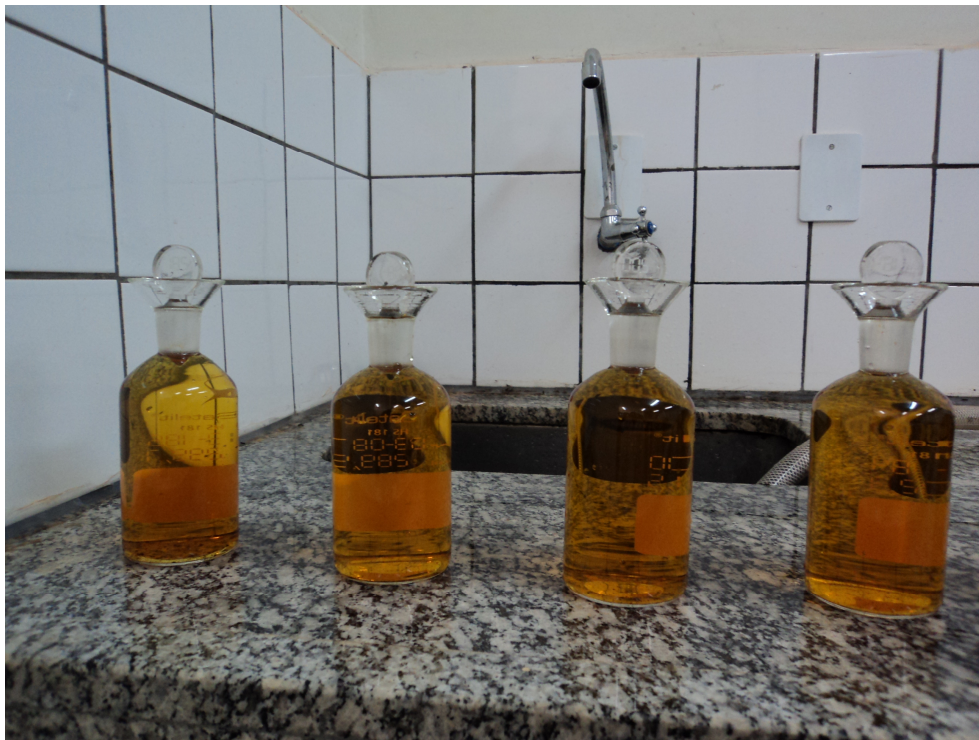
Figura 06: Análise de demanda bioquímica de oxigênio da vinhaça. Após a adição de ácido sulfúrico.
