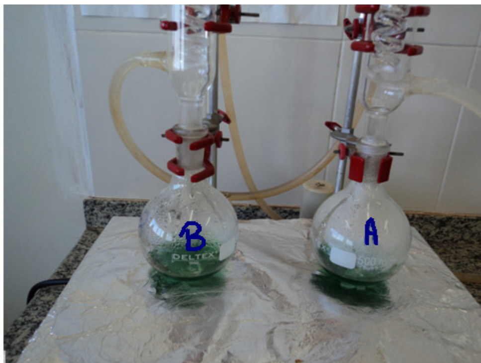
Figura 07: Análise de demanda química de oxigênio da vinhaça. Após conectar o balão com a amostra e o branco no sistema de refluxo.
