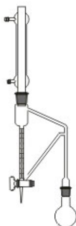
Figura 03. Aparelho do tipo Clevenger semelhante ao utilizado na extração dos óleos essenciais. (Glassco Labware® – Clevenger Apparatus)
