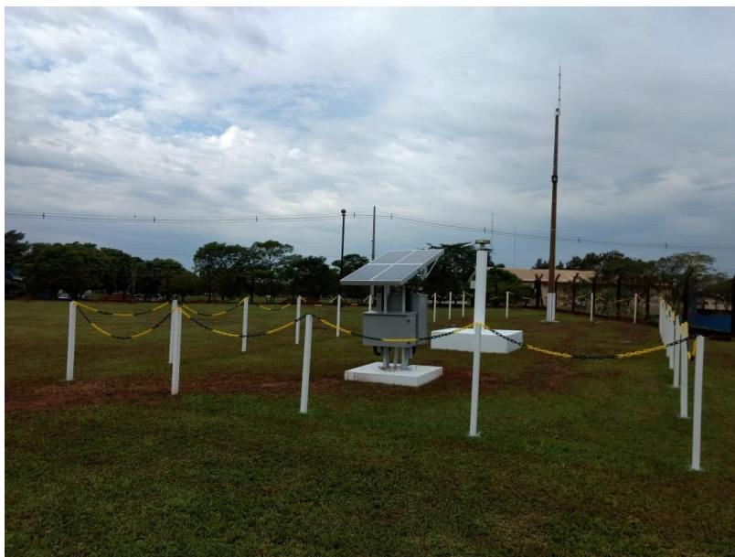
Figura 03. Vista da Estação Meteorológica do Sistema Global de Navegação por Satélite (GNSS) da Universidade Estadual de Mato Grosso do Sul – Unidade Universitária de Mundo Novo.
