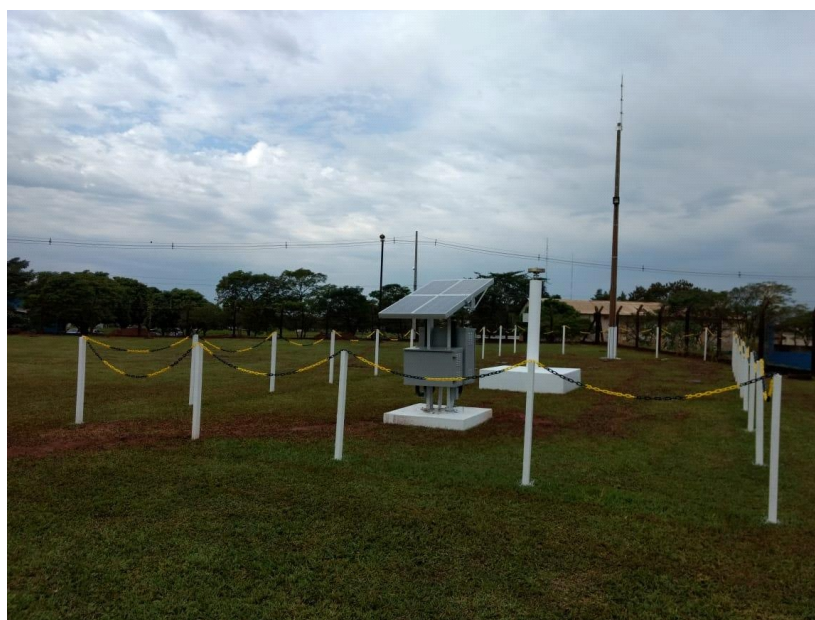
Figura 03. Vista da Estação Meteorológica do Sistema Global de Navegação por Satélite (GNSS) da Universidade Estadual de Mato Grosso do Sul – Unidade Universitária de Mundo Novo.
