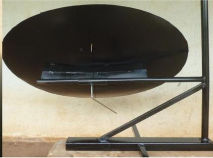
Figura 10. Superfície coletora acoplada ao suporte.
