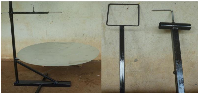
Figura 11. Suporte da superfície absorvedora / Figura 12. Suporte separados da superfície absorvedora.
