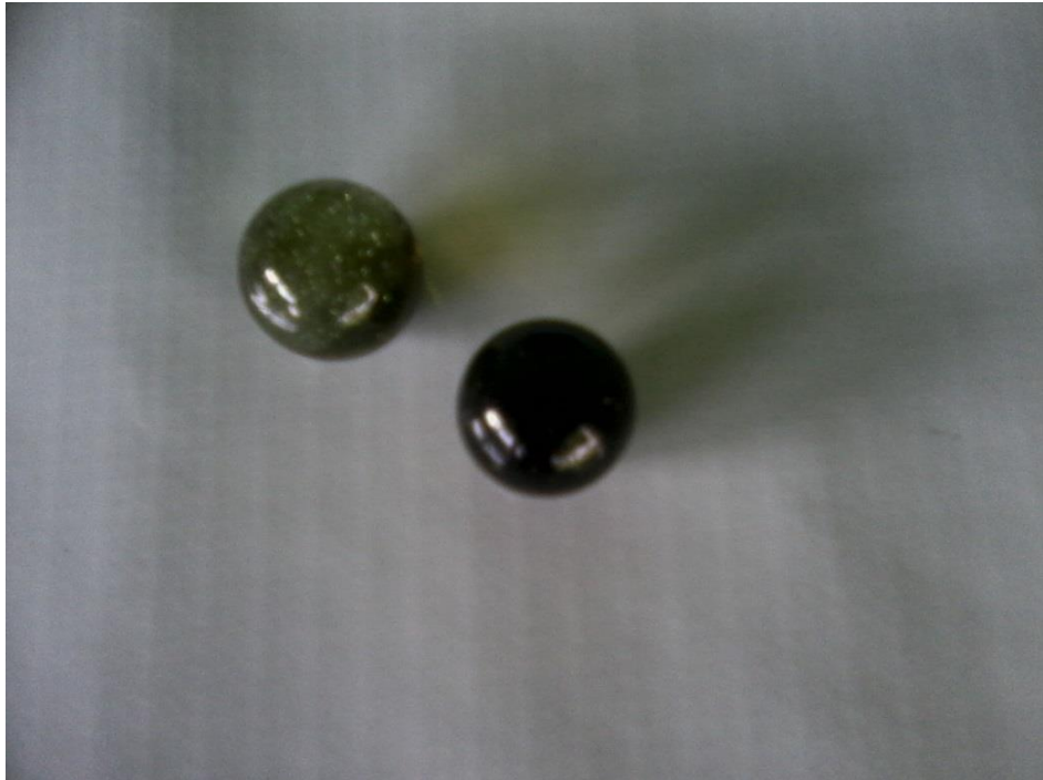
Figura 26- a) Esferas de vidro antes de serem encapadas. [Autoria própria]
