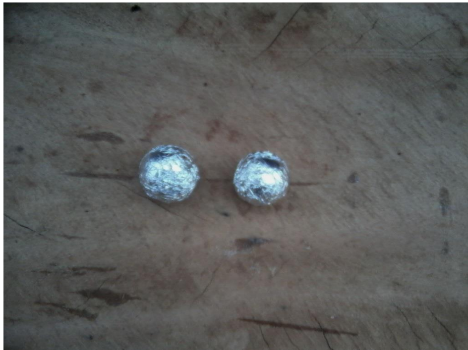
Figura 26- b) Esferas de vidro após serem encapadas com papel alumínio. [Autoria própria]
