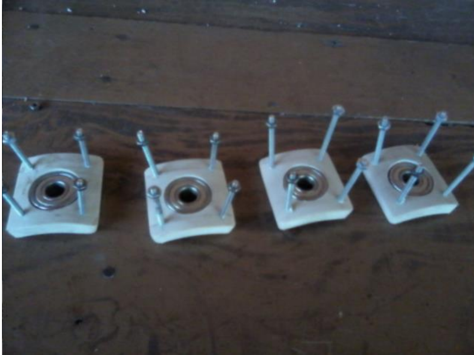
Figura 23- Mancais com os rolamentos e os parafusos. [Autoria própria]
