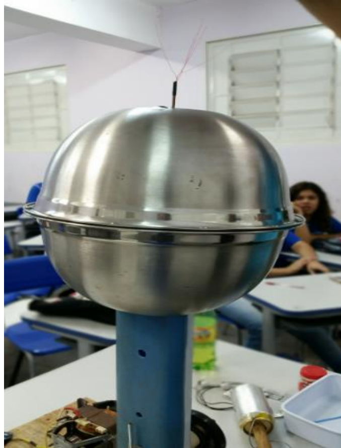
Figura 28- Demonstração do eletroscópio de linhas. [Autoria própria]
