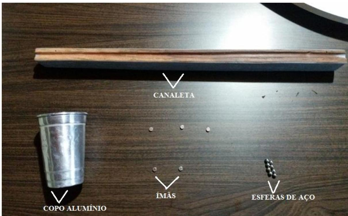
Figura 13 – Aparato instrumental utilizado no segundo experimento: Canhão de Gauss. [Autoria própria]
