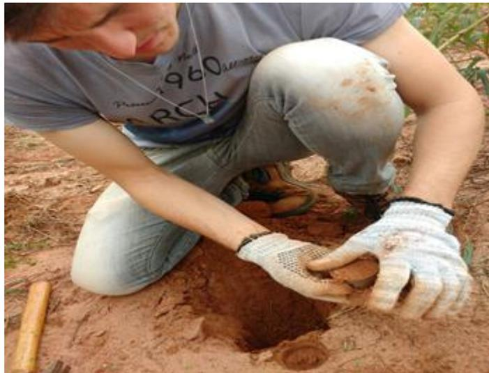
Figura 4 — Coleta de amostra física de solo (anel de Kopeck).
