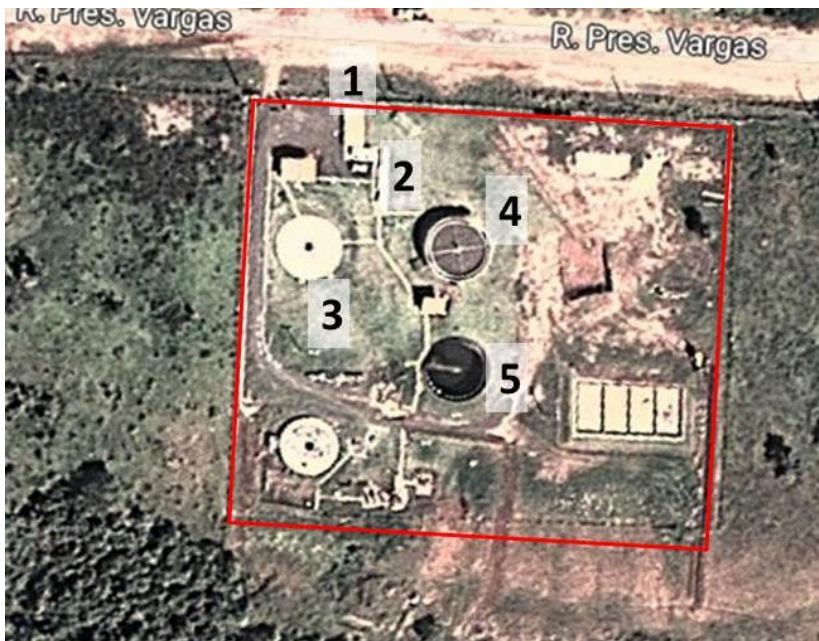
Figura 2 – Imagem aérea da ETE Iguatemi e as respectivas etapas do tratamento.
