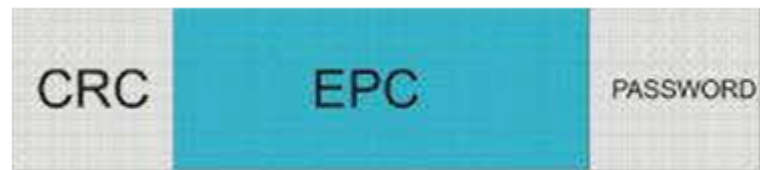
Figura 2.13: Composição de um número EPC Fonte: EPC-RFID (2013)
