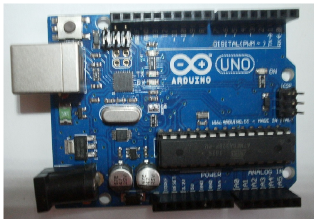
Figura 3.2: Arduino Uno R3
