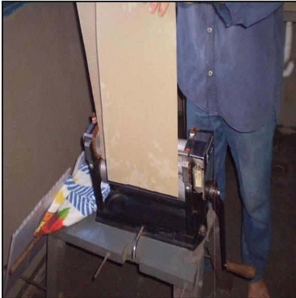
**Foto 7** - equipamento para cilindrar a cera
