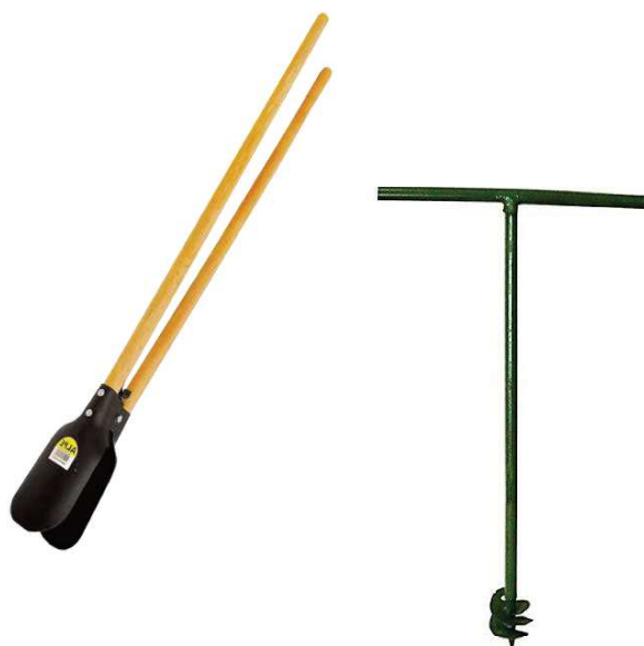
Figura 4 – Ferramentas utilizadas para a perfuração dos poços. À esquerda Cavadeira articulada; à direita Trado de rosca manual, com 3 metros de haste.
