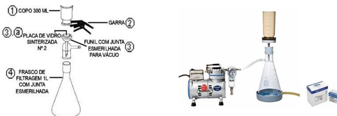
Figura 13 - Sistema de filtração utilizado para quantificação de sedimentos em suspensão. O sistema compõe de uma bomba a vácuo, vidrarias e filtros de microfibra de vidro.
