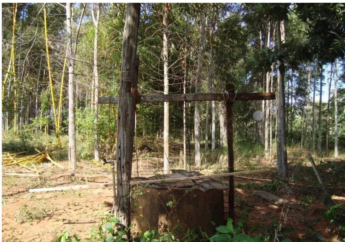
Figura 19 - Poço utilizado para medição do nível de água subterrânea situada em meio à plantação de eucalipto.
