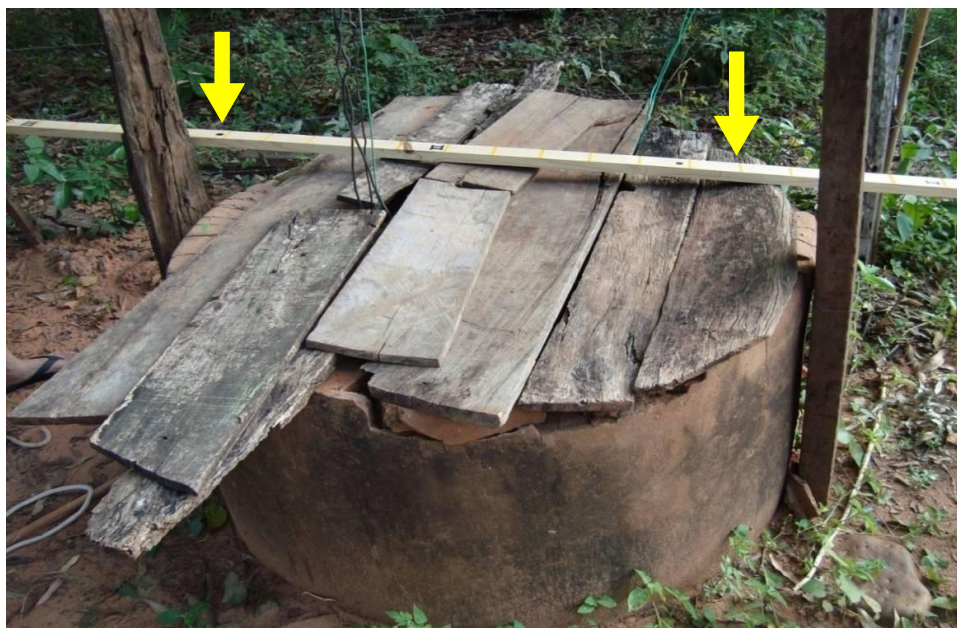
Figura 22 – Fotografia do poço analisado. As setas indicam a haste de madeira utilizada para realização das medidas do nível de água.
