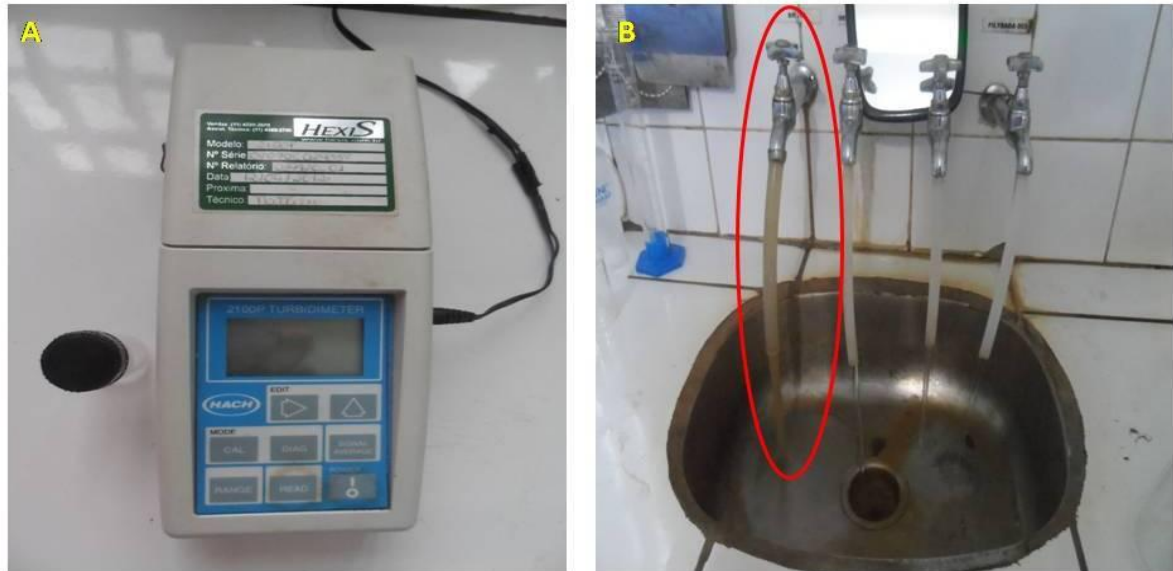
Figura 14 –Processo de análise de turbidez. No quadro A, o turbidímetro modelo 2100P da marca HACH utilizado para a análise coleta de amostras de água do rio Miranda. No quadro B, em destaque a torneira com vazão de água bruta (direta do rio Miranda) cuja análise de turbidez é realizada a cada 1 hora do dia para controle de qualidade do tratamento de água para o abastecimento urbano.
