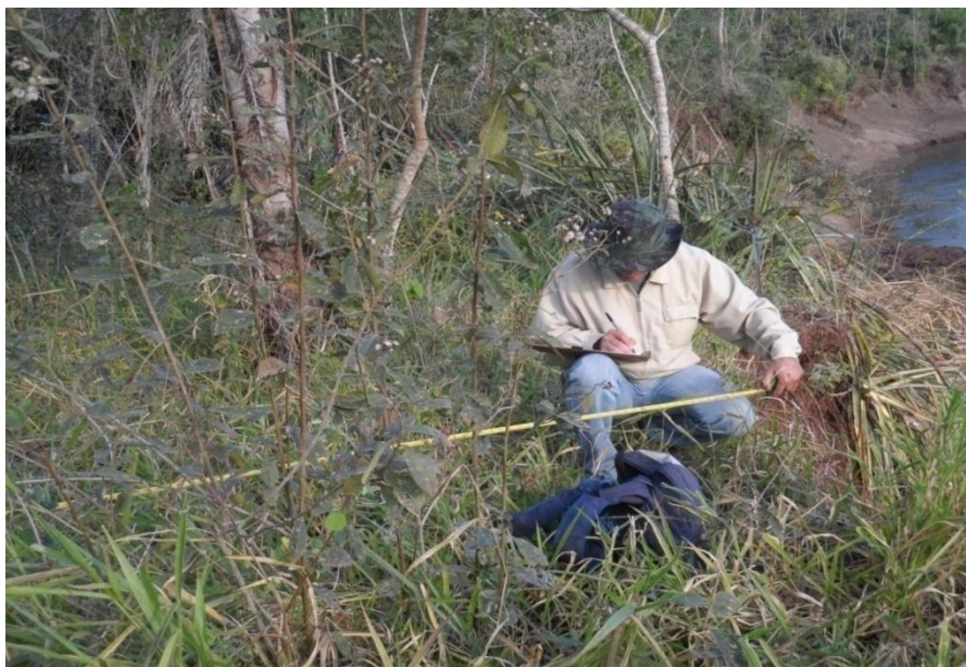
Figura 23 - Cena de coleta de dados pelo método de estaca. Neste ponto o recuo linear atingiu 320 cm. A imagem mostra parte da trena usada para a medição da estaca até a margem.
