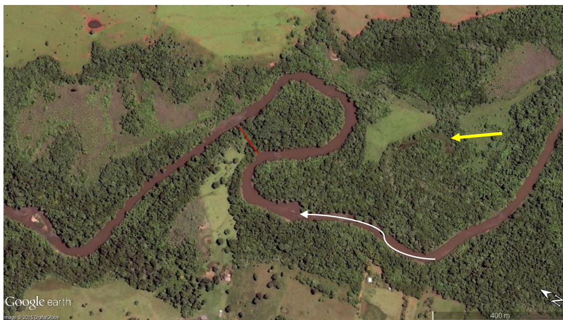
Figura 20 - Trecho com grande possibilidade de rompimento de meandro no futuro. A seta de cor branco indica o sentido do fluxo do rio Miranda. A linha vermelha entre os canais no meandro mede 100 metros. A imagem revela também que já ocorreu mudanças de canal testemunhada pela existência de lago de meandro abandonado (oxbow lake) indicado pela seta amarelo podemos encontrar na área de Jardim/MS.
