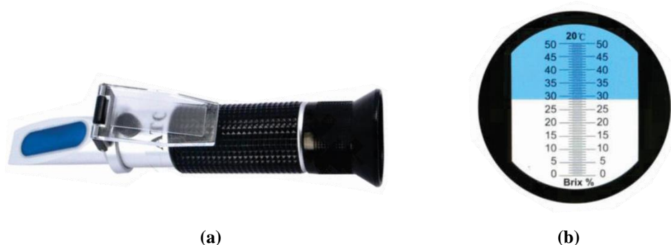
Figura 2.11- (a) Refratômetro manual com escala em °Brix. (b) visor indicando o grau Brix.
