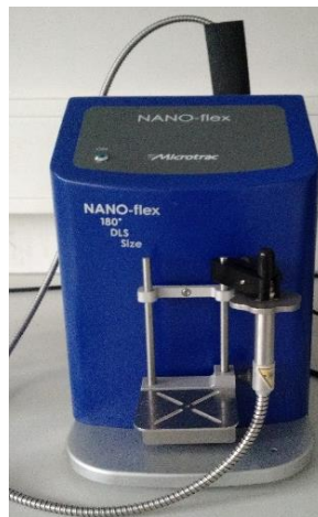
Figura 3.13- Equipamento de espalhamento de luz dinâmica Nano-Flex 180°. A amostra é colocada para análise diretamente no laser.
