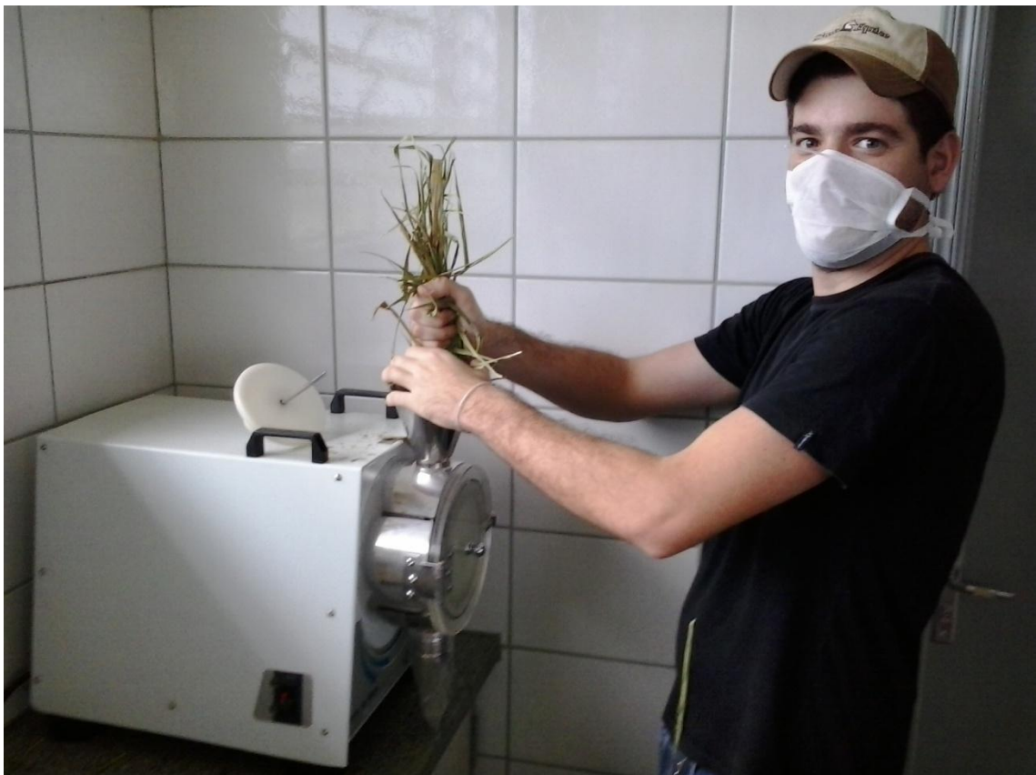
FIGURA 9. Moagem da parte aérea, utilizando moinho Wiley
