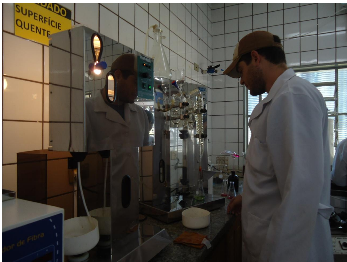
FIGURA 10. Destilador de nitrogênio para determinação de proteína bruta
