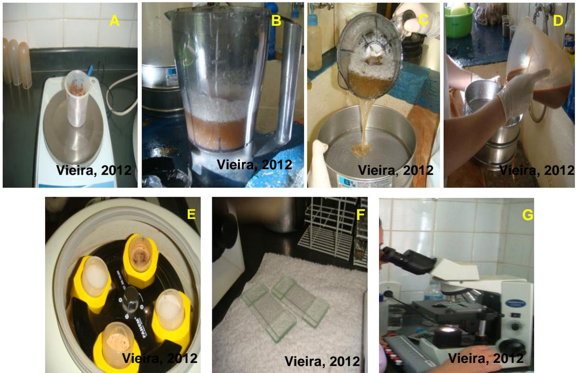
FIGURA 3. A: Pesagem das raízes; B: Trituração das raízes; C: Peneiramento das raízes trituradas; D: Peneiramento do solo; E: Passagem das amostras pela centrífuga; F: Câmara de Peters; G: Identificação dos nematoides em microscópio ótico.
