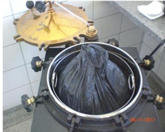
**FIGURA A9.** Esterilização de substrato em autoclave. UEMS, Cassilândia – MS. 2012.
