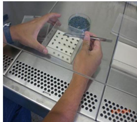
**FIGURA A6.** Sementes sendo colocadas no papel mata borrão nos gerboxs para blotter test. UEMS, Cassilândia – MS. 2012.
