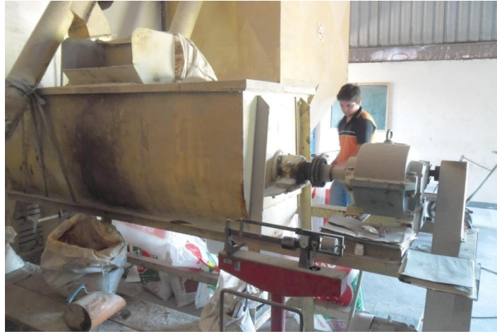
FIGURA 14. Misturador horizontal. FORTMIX – Cassilândia/MS, 2012. Fonte: Prado, P. P.
