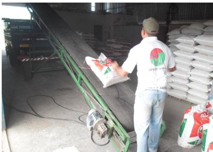
FIGURA 23. Esteira para auxílio da subida dos sacos. FORTMIX – Cassilândia/MS, 2012. Fonte: P.P. Prado
