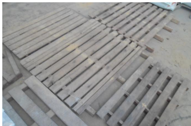
FIGURA 20. Estrados para empilhamento dos sacos de ração. FORTMIX – Cassilândia/MS, 2012. Fonte: P.P. Prado
