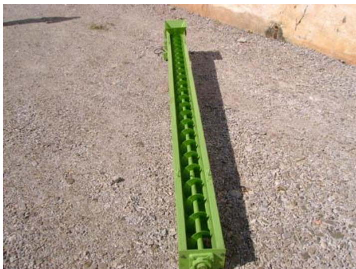
FIGURA 6. Tubo de condução (rosca sem fim). Fonte: www.ominsa.com.br
