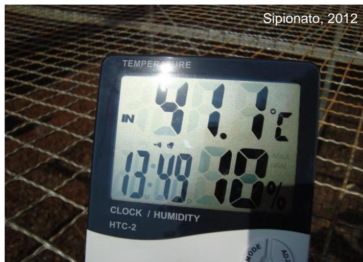
FIGURA 10. Higrômetro e termômetro digital empregado na coleta diária das médias de temperaturas e umidade relativa do ar durante o experimento. UEMS, Cassilândia – MS, 2012.
