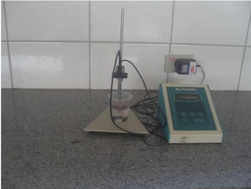
FIGURA 12. Condutivímetro, utilizado para medição de condutividade elétrica. Laboratório UEMS/Cassilândia, MS.
