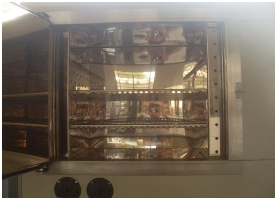
FIGURA 3. Estufa utilizada para teste de determinação do teor de água. Laboratório UEMS/Cassilândia, MS.
