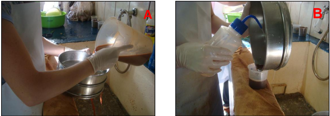
FIGURA 4: A. Amostra sendo filtrado em uma peneira; B. O material retido na peneira sendo encaminhado a um Becker.
