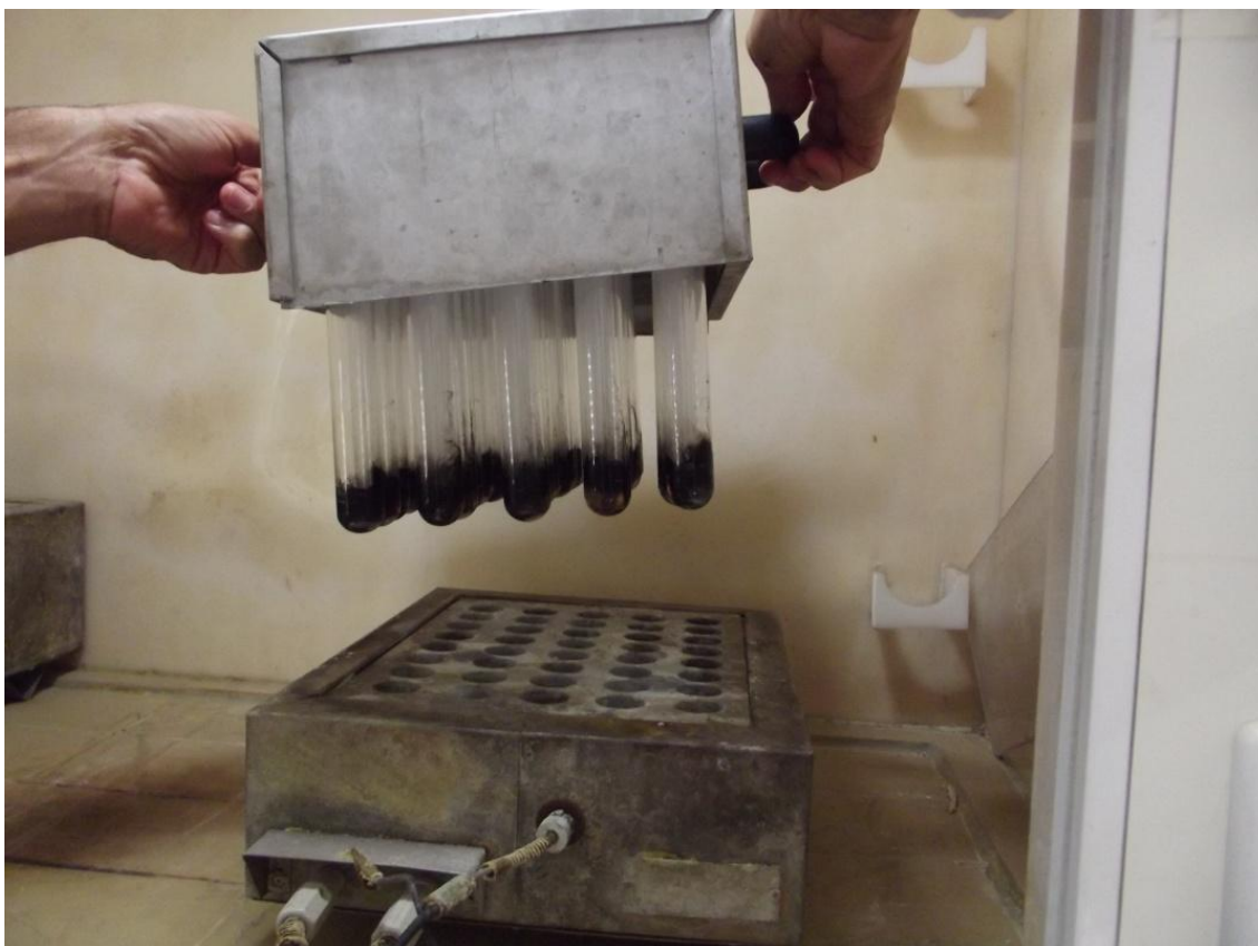
FIGURA 17 – Colocação dos tubos na capela. UNESP, Ilha Solteira – SP, 2013.
