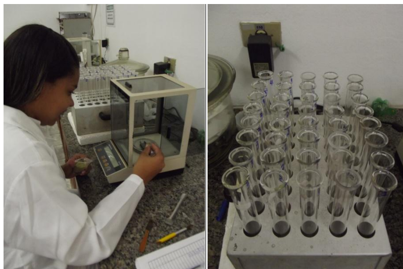
FIGURA 6. Pesagem e preparo das amostras no tubo de ensaio para destilação, UNESP, Ilha Solteira, 2013.
