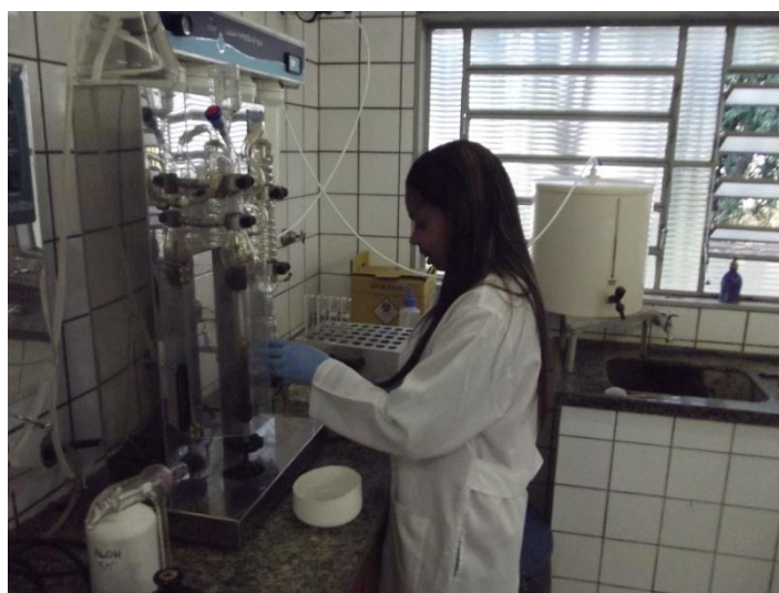
FIGURA 7. Destilação, para determinação do teor de proteína bruta, UNESP, Ilha Solteira, 2013.
