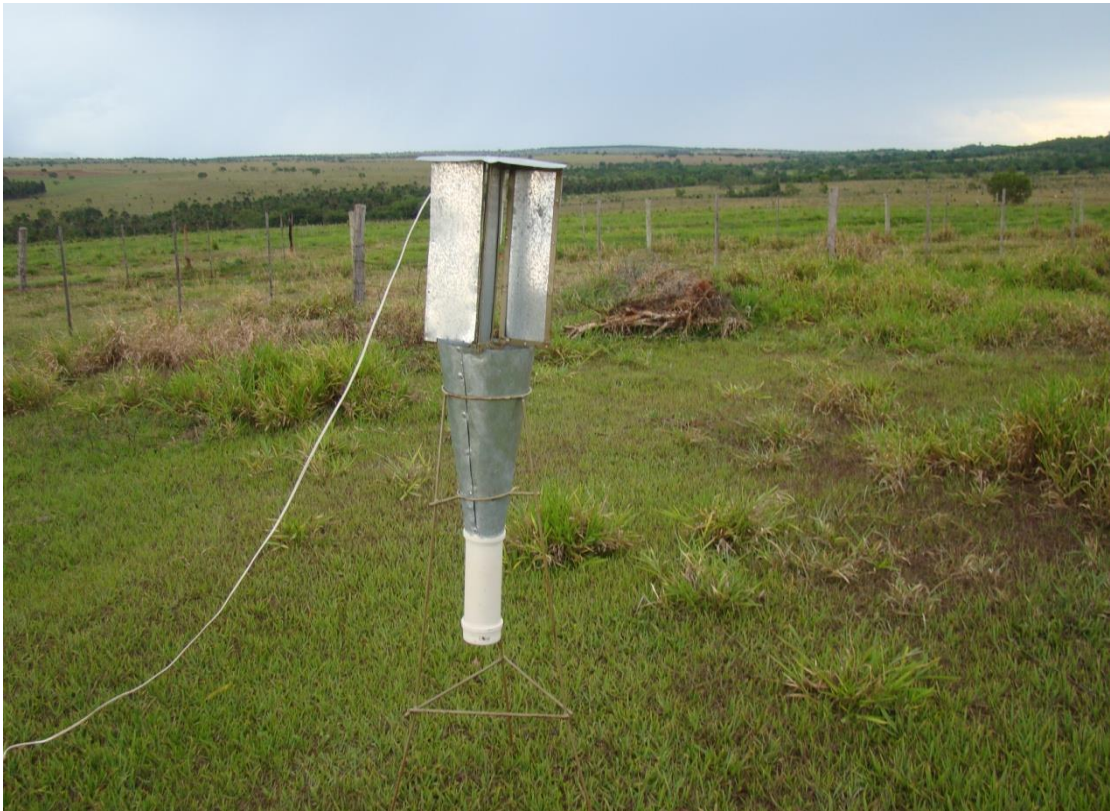
FIGURA 1. Armadilha modelo “Luiz de Queiroz” utilizado para coleta de Scarabaeidae.
