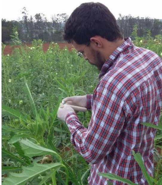
FIGURA 3. Mensuração do índice relativo de clorofila das folhas com o uso do clorofilômetro CCM-200.
