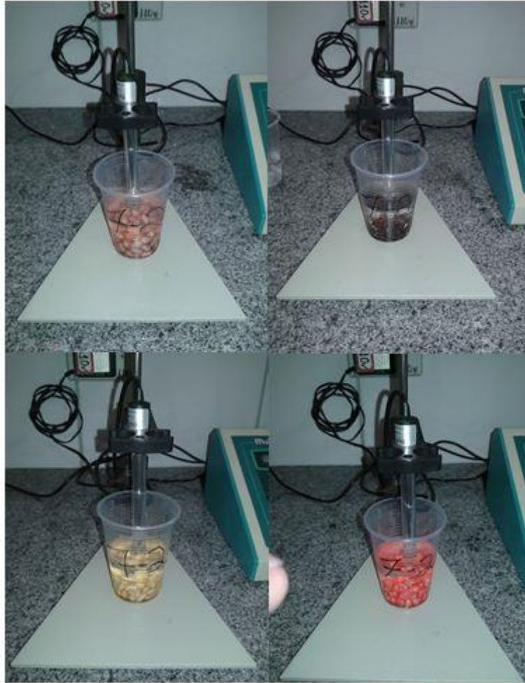
FIGURA 11: Teste de condutividade elétrica
