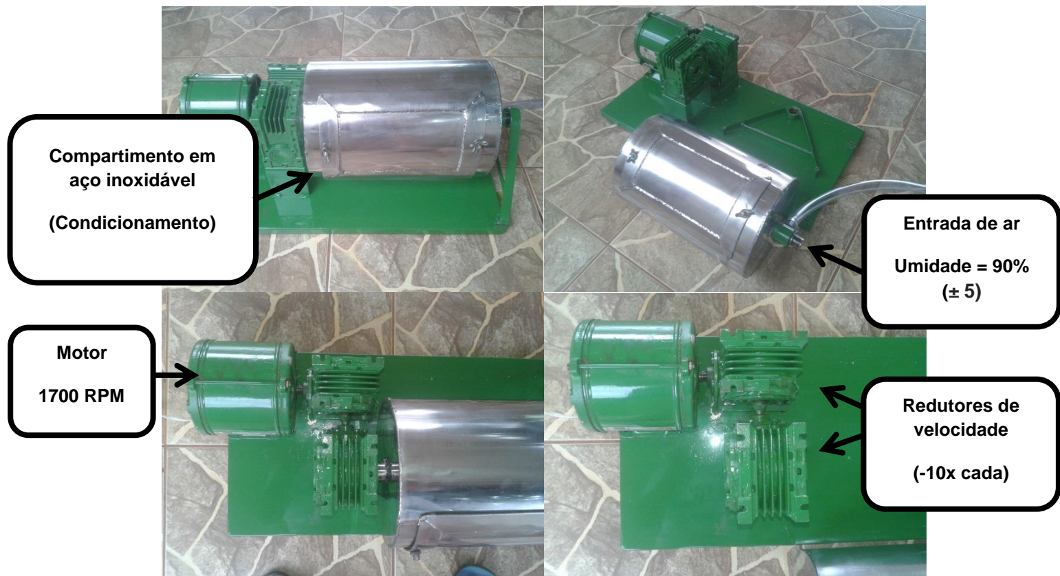
FIGURA 3: Protótipo para condicionamento fisiológico de sementes
