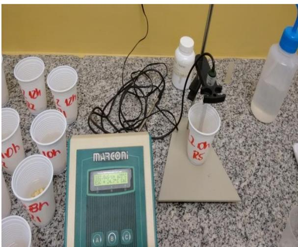
Figura 5: Teste de condutividade elétrica
