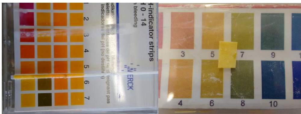
Figura 20 – Resultado de dois testes de pH realizados durante o processo de mosturação.
