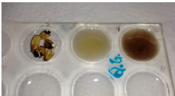
Figura 21 – Teste de iodo positivo para mosturação com 40% de água.
