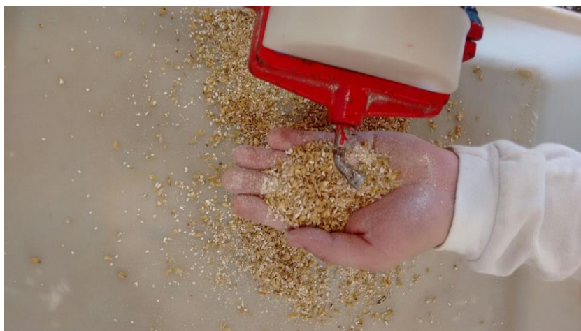
Figura 15 - Ponto de moagem dos maltes obtido com o moinho de disco.
