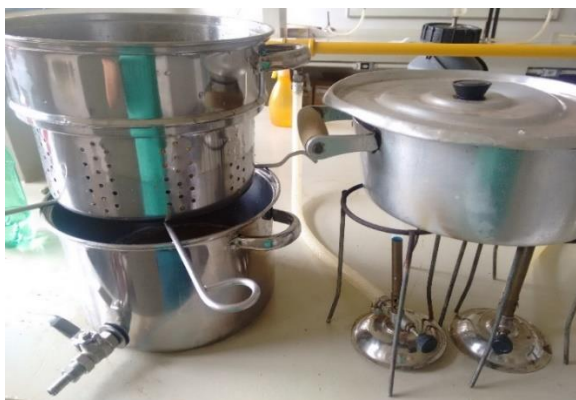
Figura 23 – Montagem do equipamento utilizado para a filtração do mosto cervejeiro.
