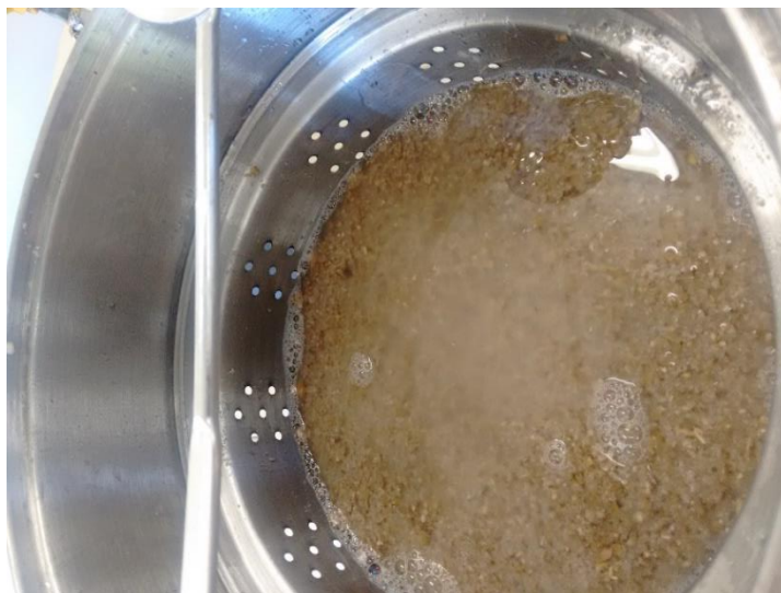
Figura 25 – Processo de lavagem da cama de grãos para obtenção do mosto secundário.
