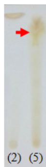
Figura 6 - CCD da substância galoil N -pirrol-carboxamida (5), em CHCl 3 /MeOH 30%, revelada com vapor de iodo.
