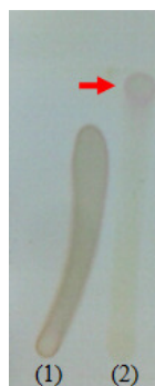
Figura 4 - CCD da substância metil galato (2), em \text{CHCl}_3/\text{MeOH} 30%, revelada com vapor de iodo.
