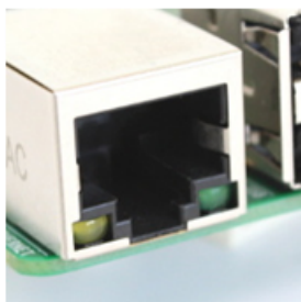
Figura 8 – Led de atividade da placa de Ethernet
