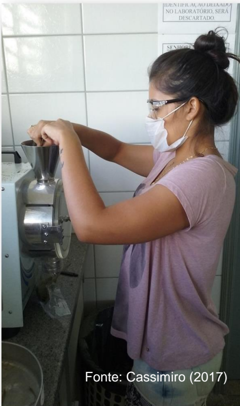
Figura 7. Amostras moídas em moinho de facas tipo Cróton com peneira de 1 mm.
