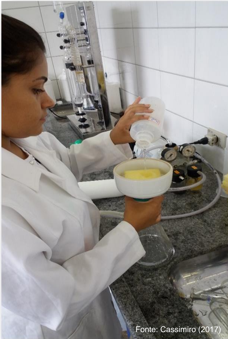
Figura 12. Espumas lavadas em funil de Buckner com placa porosa ligado a uma bomba de vácuo
