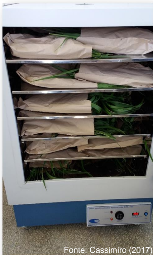
Figura 5. Amostras em estufa de ventilação forçada de ar, com temperatura entre 60 e 65°
