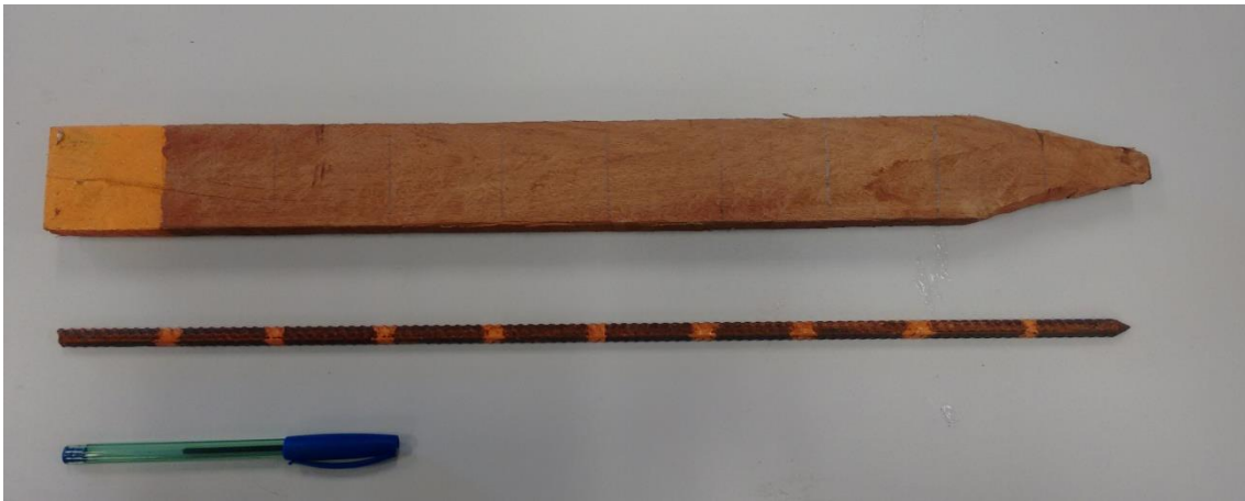
Figura 3 - Estaca de madeira e pino de aço utilizado na pesquisa.
