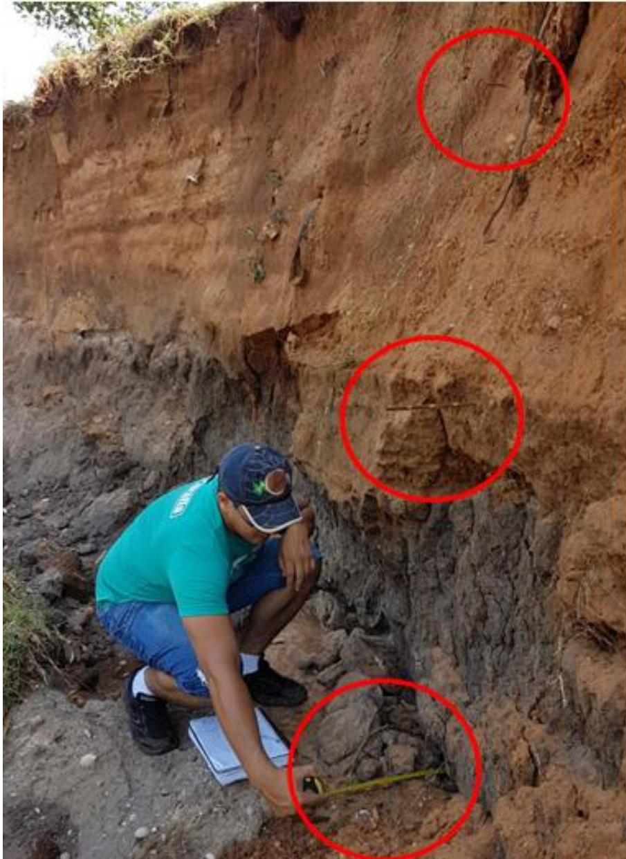
Figura 31 - Coleta de dados dos pinos de aço na seção 05, em outubro/2017. Fonte: Elaborado pelo autor.
