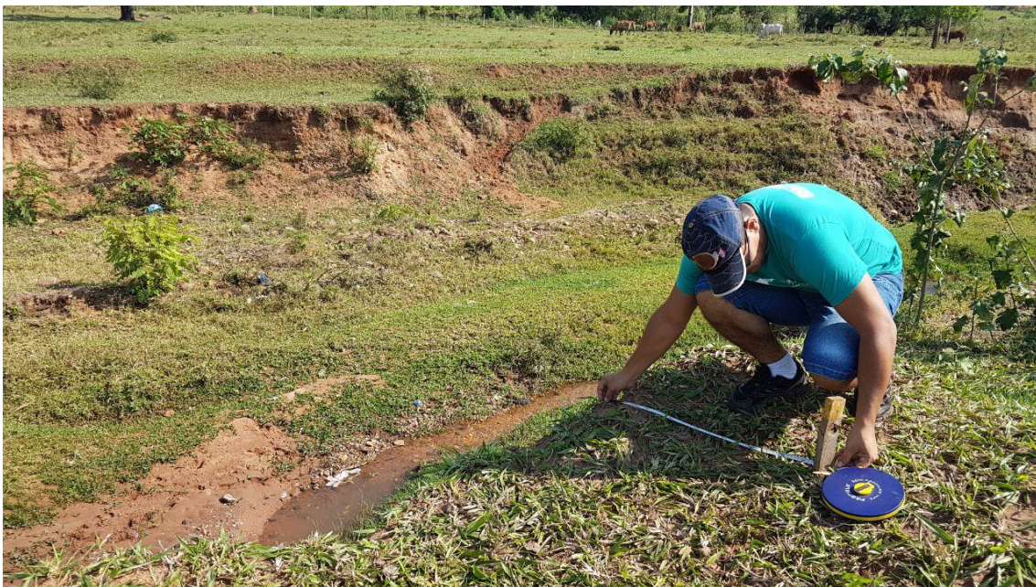
Figura 20 - Coleta de dados da estaca na seção 01. Registro do avanço da erosão no talude da seção monitorada, restando apenas 0,8 metros da margem até a estaca de madeira.
