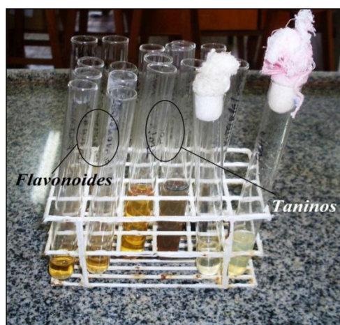
Figura 6 - Resultado do teste analítico para flavonoides e taninos em extratos etanólicos brutos de A. alata (Foto: Alexandre, 2012).
