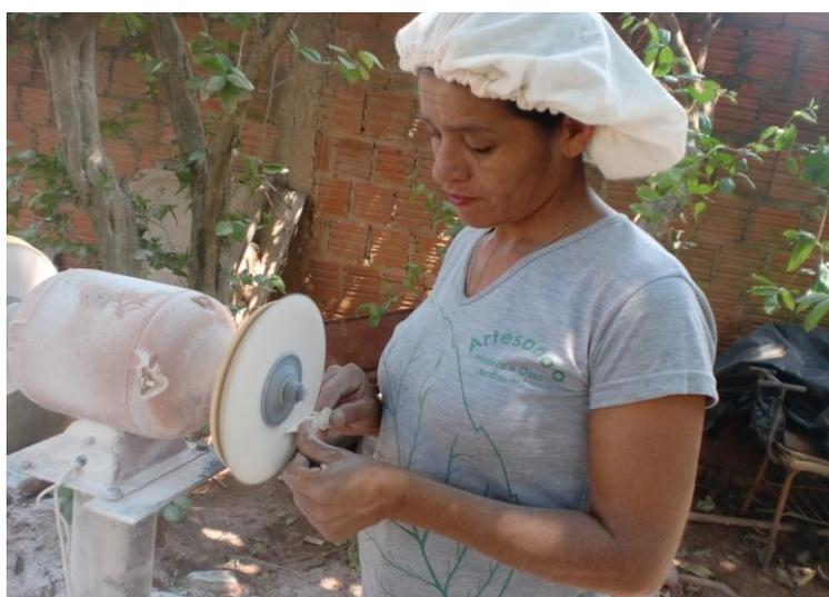
**Figura 10:** Artesã lixando os ossos no Esmeril (lâminas de ossos).
