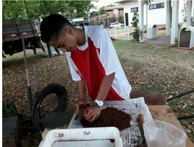
Figura 3. Processo de destorroamento das amostras de solo.
