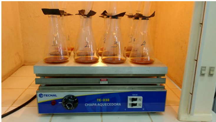
Figura 4. Amostras em chapa aquecida a 170°C por 30 minutos. Detalhe para os condensadores feitos com tubo de ensaio e borracha, e inseridos na parte superior dos erlenmeyers.
