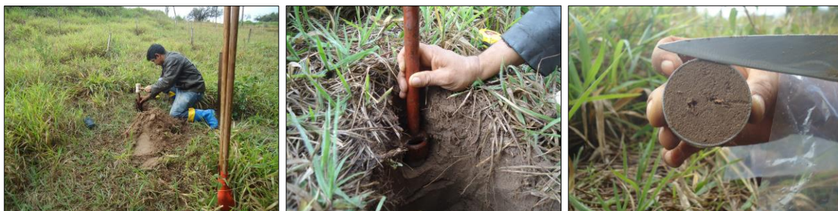
Figura 9. Coleta de amostra indeformada para determinação da densidade do solo.
