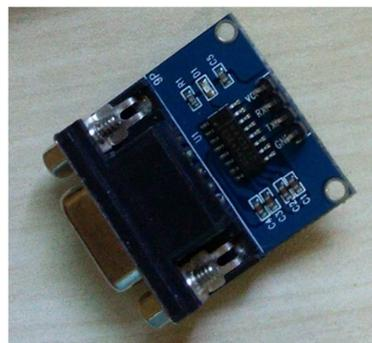
Figura 4 Componente RS232 DB9
