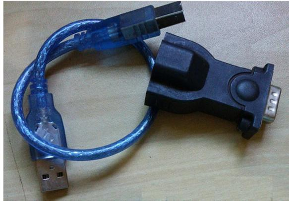
Figura 3 Adaptador USB Serial
