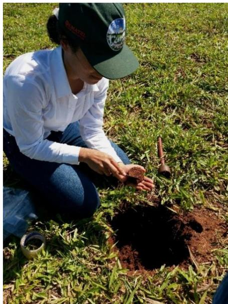
Figura 4. Coleta de amostras indeformadas do solo com auxílio do anel de Kopeck.
