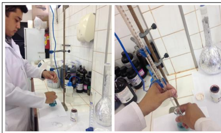
Figura 11. Processo de titulação do carbono orgânico total.
