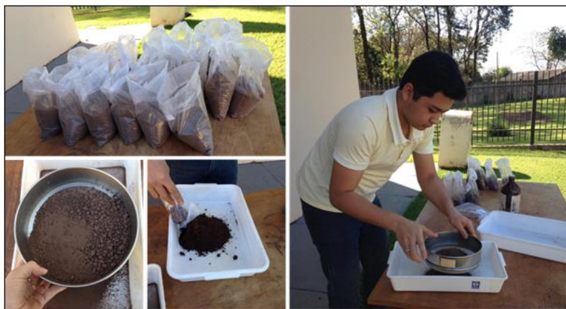
Figura 9. Destorroamento e peneiramento das amostras deformadas de solo.
