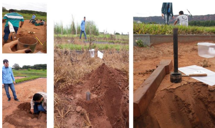
Figura 7. Coleta das amostras deformadas de solo com auxílio do anel volumétrico nas diferentes parcelas experimentais.
