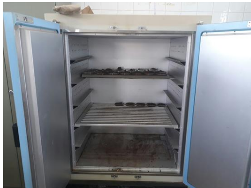
Figura 8. Amostras em estufa para posteriormente serem realizadas as pesagens para análises de densidade do solo.
