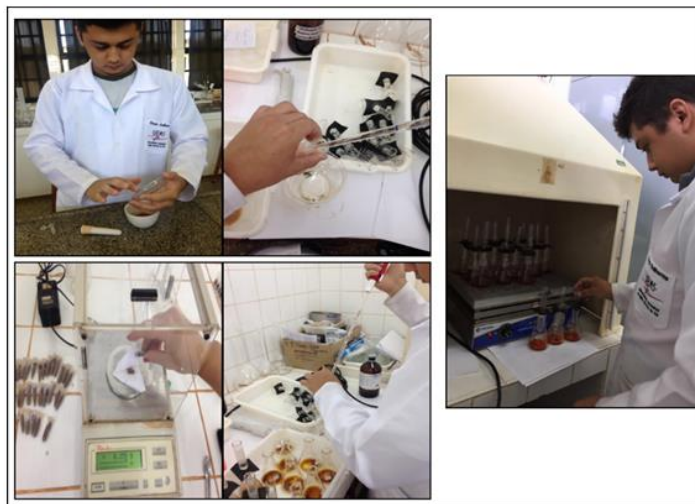
Figura 10. Preparo das amostras para a determinação do carbono orgânico total.
