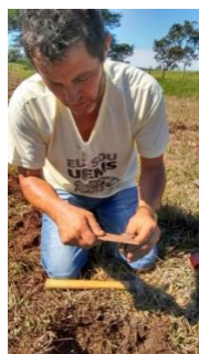
Figura 6. Coleta de amostra indeformada de solo com auxílio do anel volumétrico.
