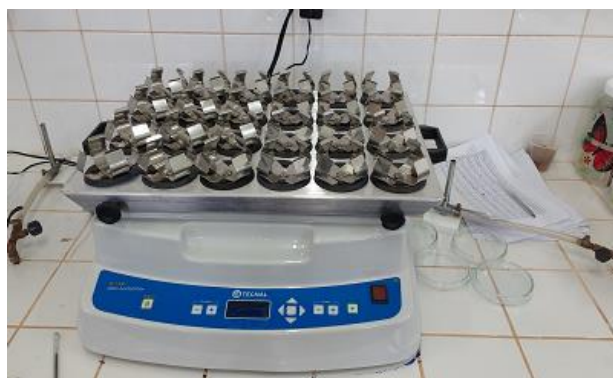
Figura 9. Agitador horizontal utilizado para o fracionamento físico granulométrico da MOS.
