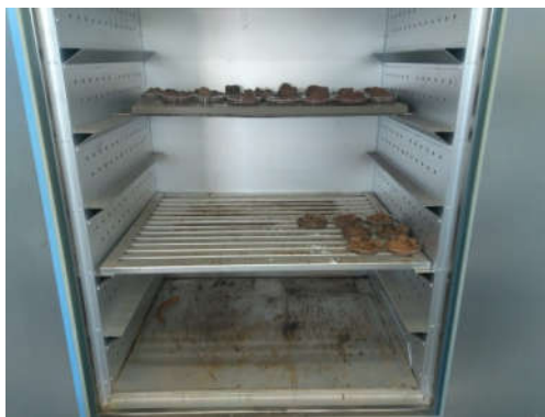
Figura 8. Amostras em processo de secagem em estufa a 105 °C por 48 h.
