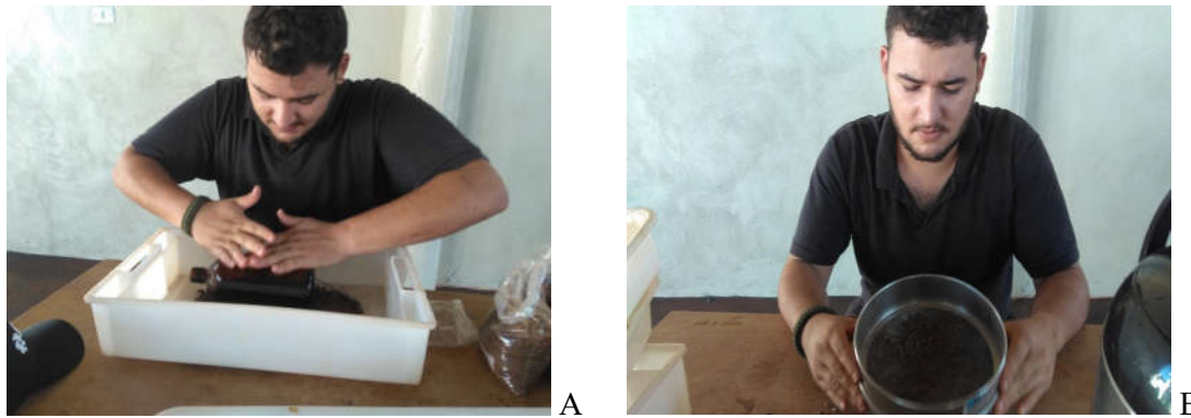
Figura 5. A) Processo de destorroamento do solo. B) Peneiramento das amostras em peneira 2 mm para a formação da terra fina seca ao ar (TFSA).
