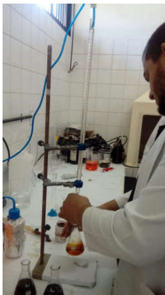
Figura 10. Adição de dicromato de potássio para determinação do teor de COT.
