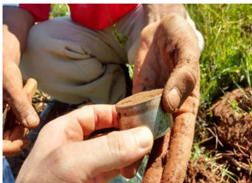
Figura 4. Coleta de amostra com auxílio do anel volumétrico para determinação de para a determinação de densidade.
