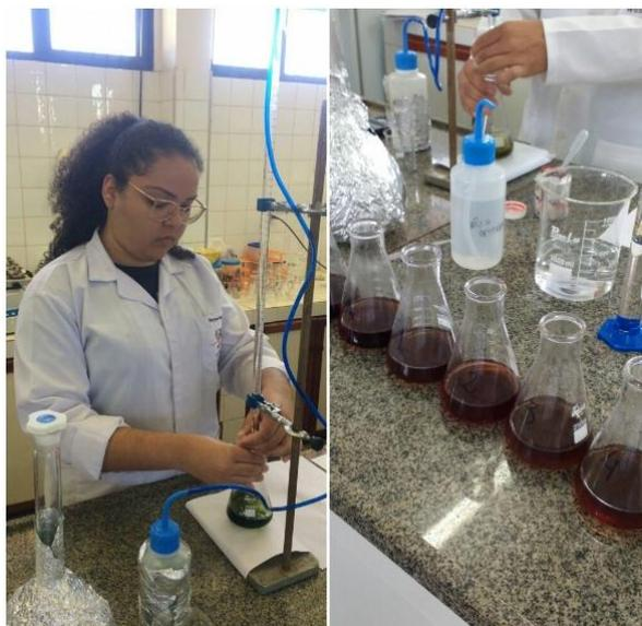
Figura 8. Processo para determinação de COT.
