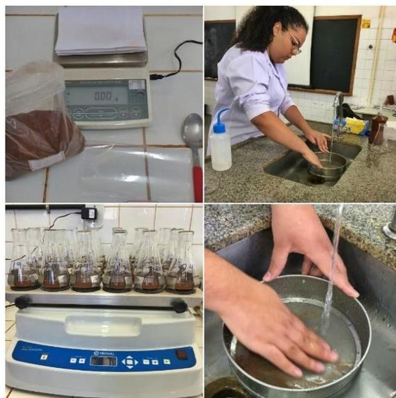
Figura 9. Procedimentos para realizar o fracionamento físico-granulométrico.
