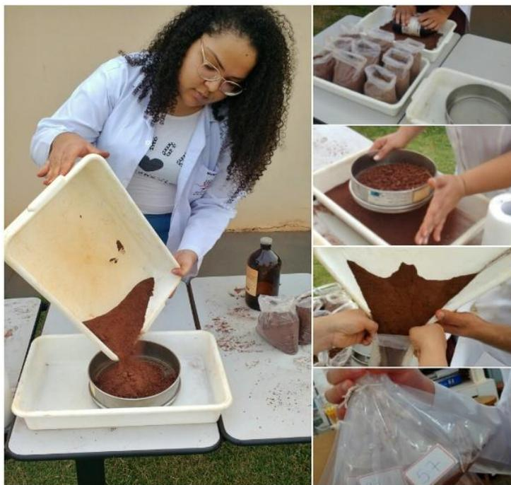
Figura 7. Destorroadamento e peneiramento das amostras de solos.
