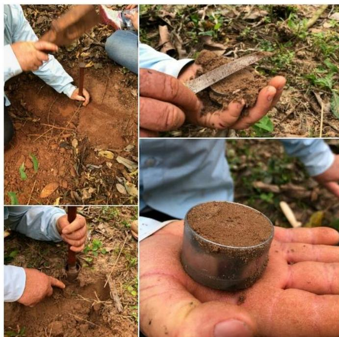
Figura 5. Coleta das amostras indeformadas de solo com auxílio de anel volumétrico.
