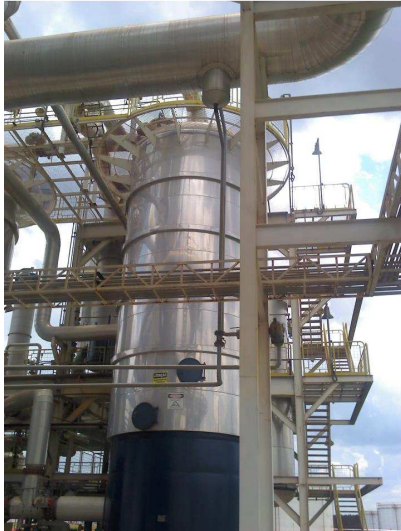
FIGURA 21 – Vaso de peneiras moleculares e zeólitas.
