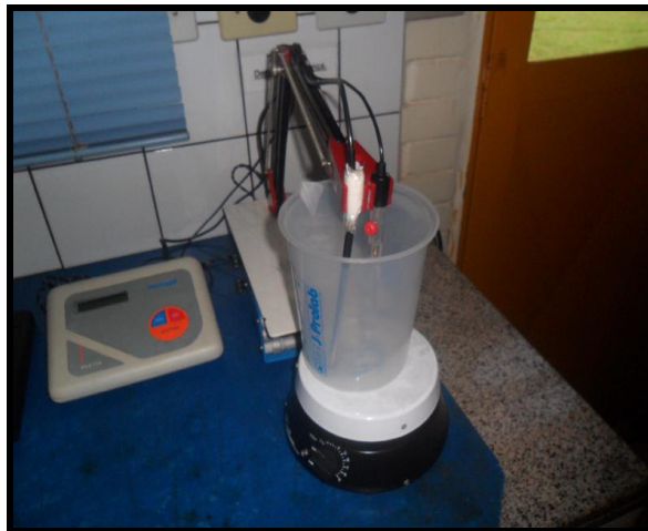
FIGURA 13 - Sistema para medidas de pH sob agitação para preparação de soluções tampão.
