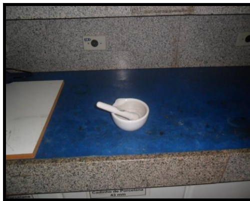
Figura 11 - Homogeneização por maceração da pasta de Carbono 1.
