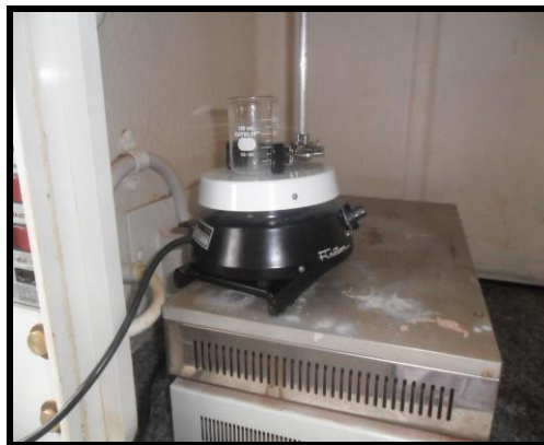
Figura 12 - Homogeneização por agitação mecânica da pasta de carbono 2.
