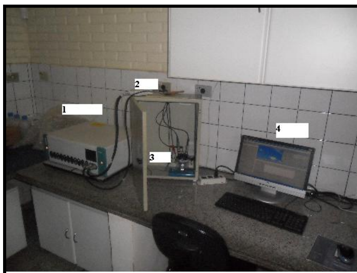
FIGURA 8 – (1) potenciostato, (2) caixa de Faraday, (3) cela eletrolítica e (4) computador interfaciado com Autolab 4.9.
