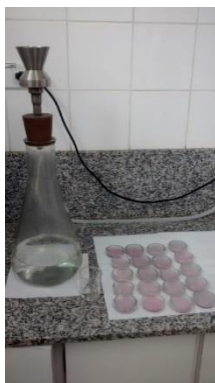
Figura 21 - Sistema de filtração a vácuo com membrana
